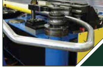
Boru Büküm Pipe Bending
