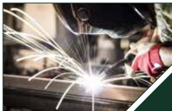
Gazaltı Kaynağı Arc Welding
